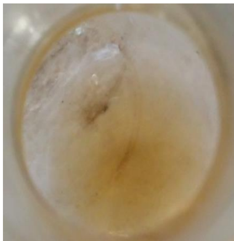
Figura 5. Queratina disuelta en [DMEA][HCOO], 3 horas de agitación, 140°C.
