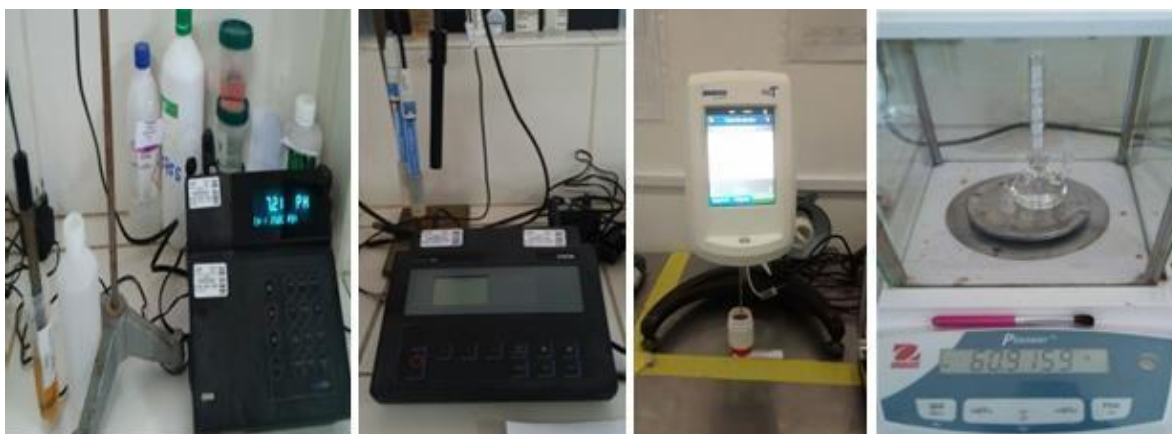
Figura 7: Instrumentos de medición utilizados en la lectura de pH, conductividad, viscosidad y densidad para [DMEA][HCOO] y [DEOA][HCOO]
