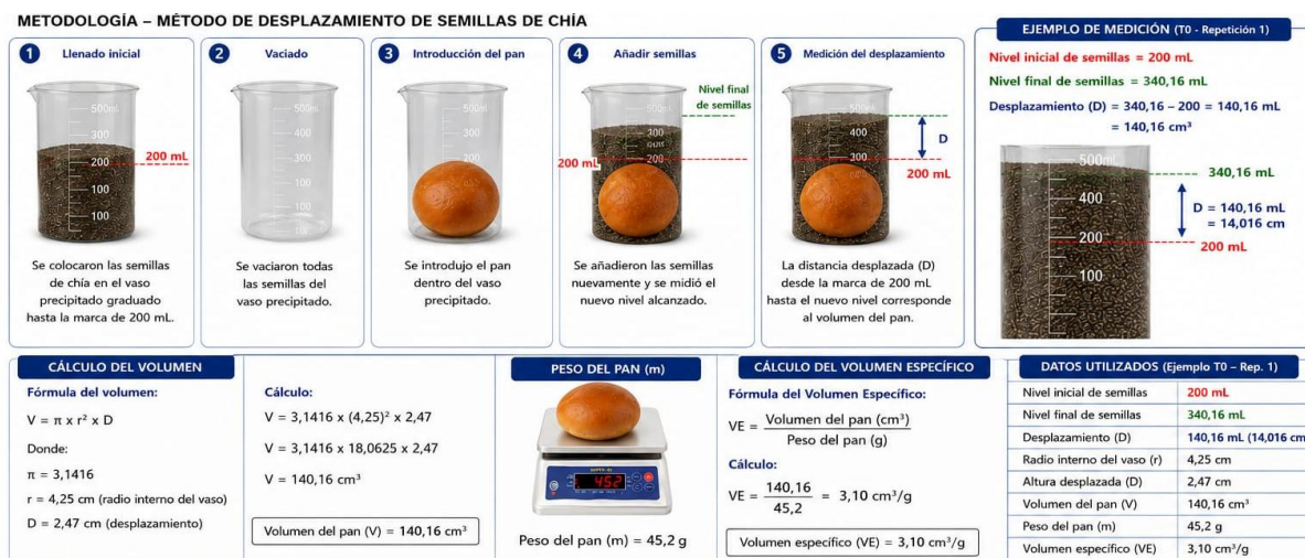
Figura 2. Metodología de desplazamiento de semillas de chía para estimar el volumen ocupado por el pan
